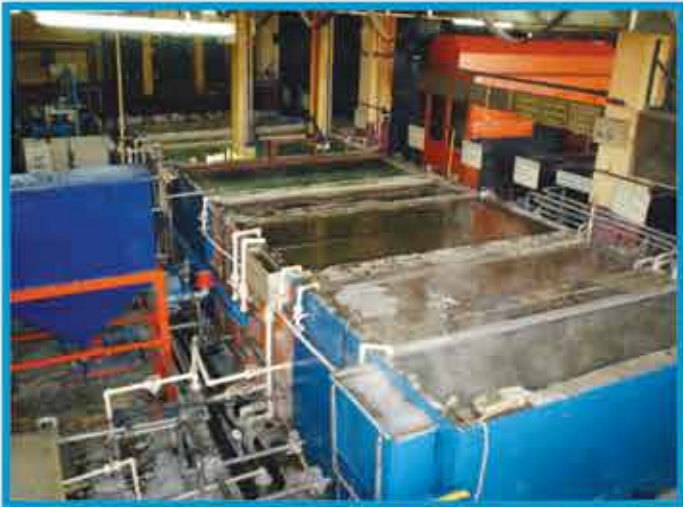
Daldırma Tip Yüzey Temizleme Hattı Dipping Type Surface Pretreatment Line
